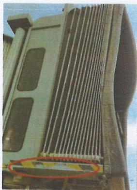
Figure 1 : Positions des impacts sur la passerelle et sur l'entrée d'air du moteur
